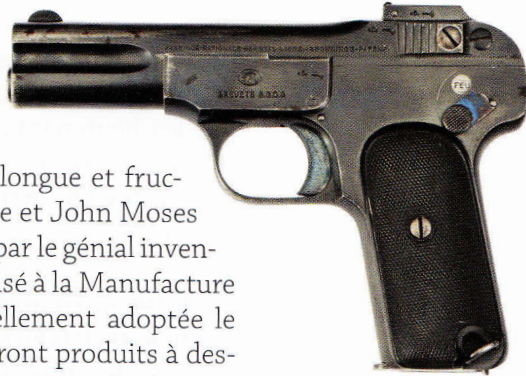
Pistolet semi-automatique FN-Browning belge, modèle 1900, d'un calibre de 7,65 mm. Fabrication par la Fabrique nationale d'armes de guerre, Herstal, avant 1903.
